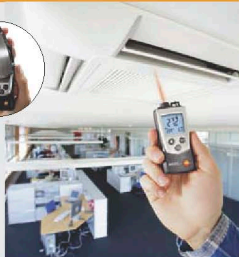
红外测量通风口的表面温度
